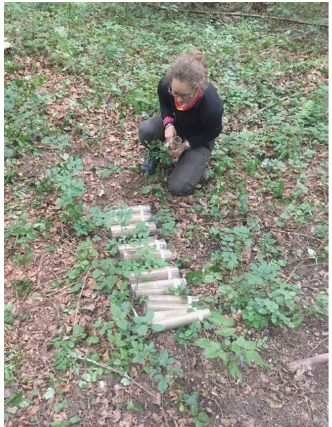
3–4 Kleiner Einblick in die Nutzung des Humax-Bohrers. Das Rohr hat einen Durchmesser von 8 cm und ermöglicht somit auch die Erfassung von Funden, wie etwa Keramik. Das Rohr wird mit einem Motor (liegt hier am Boden) in den Untergrund geschraubt. Die Resultate der Bohrung (Bohrabschnitte) sind in PVC-Hülsen gepackt (Universität Zürich).
