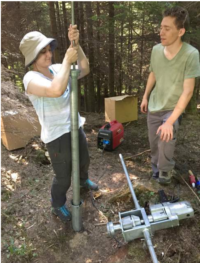
3–4 Kleiner Einblick in die Nutzung des Humax-Bohrers. Das Rohr hat einen Durchmesser von 8 cm und ermöglicht somit auch die Erfassung von Funden, wie etwa Keramik. Das Rohr wird mit einem Motor (liegt hier am Boden) in den Untergrund geschraubt. Die Resultate der Bohrung (Bohrabschnitte) sind in PVC-Hülsen gepackt (Universität Zürich).
