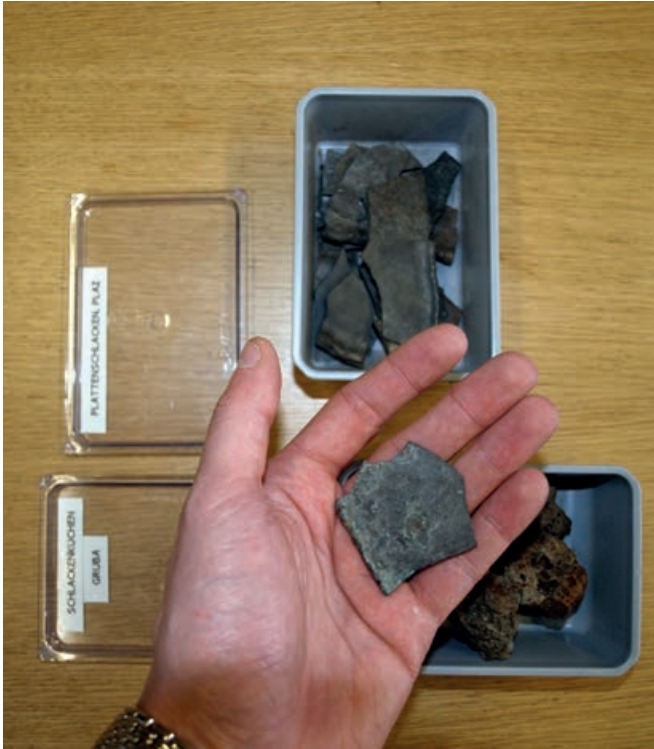
1 Demonstration von Plattenschlacken aus Graubünden anlässlich des Schlackenworkshops (Universität Zürich).
