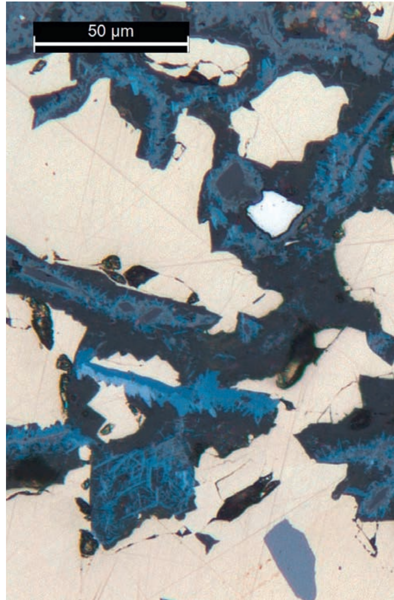
2 Anschliff einer Schlacke unter dem Mikroskop (Klaus-Peter Martinek).
